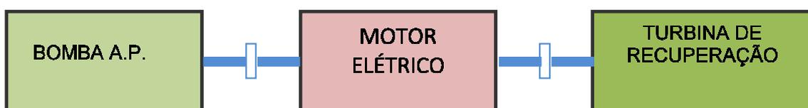
Em ambos os casos, o motor elétrico tem um eixo duplo que, por um lado, une a bomba de alta pressão que fornece energia à água do mar que é enviada para as membranas, e a outra extremidade do eixo se junta à turbina de recuperação de energia. Com esta configuração, a energia que o motor deve fornecer é a diferença entre a energia demandada pela bomba de alta pressão e a energia recuperada pela turbina.
