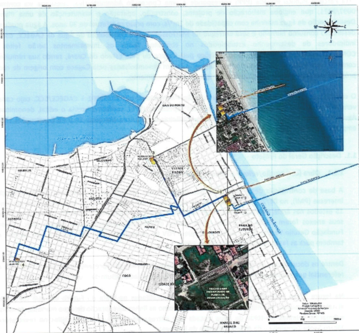
Figura 1. Localização da área da planta de dessalinização e das linhas de captação, emissário e de água tratada.
