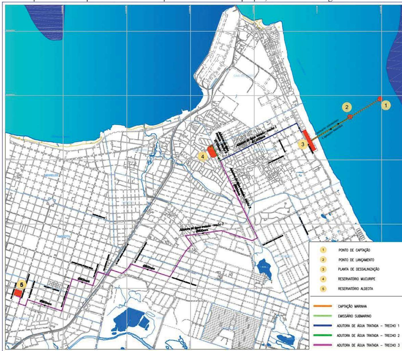
Figura 2. Layout das principais unidades componentes da planta.
